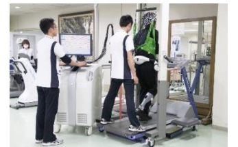
歩行アシストを装着した運動中の 脳の活動をSMART NIRSで計測
