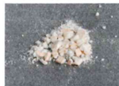
図：ハンマーで容易に粉砕 (粉砕条件：金属製のハンマーにて、1回/秒 形状に変化がなくなるまで粉砕)
