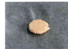
図：ハンマーで粉砕が困難 (粉砕条件：金属製のハンマーにて、1回/秒 形状に変化がなくなるまで粉砕)
